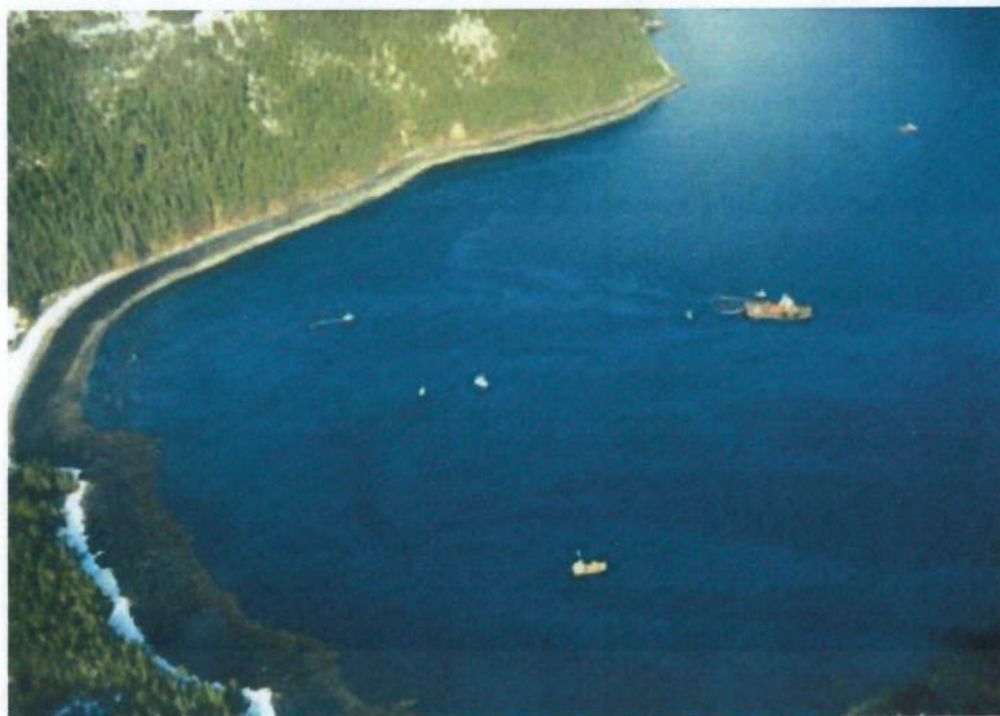
Figura 3 - Coleta de óleo flutuante por escumação ( skimming ) foi um método eficiente de limpeza. Fonte: Stanley et al., 2007.
